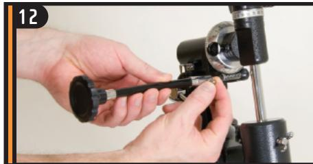
Far scivolare sull'albero del meccanismo della montatura equatoriale l'estremità cromata del cavo di controllo del movimento lento e serrare la vite per fissarlo in posizione.
