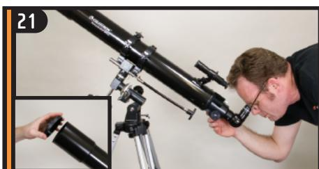
Retirez le cache de la lentille placé sur l'avant du télescope. Pour observer, regardez dans l'oculaire comme illustré ci-dessus.
