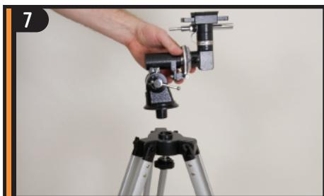
Die parallaktische Montierung nehmen und das Unterteil der Montierung in die Öffnung in der Mitte der Stativplattform setzen.
