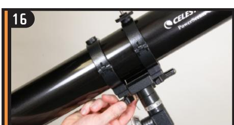
Remettez les deux boutons et serrez pour maintenir en position. L'avant du tube doit être positionné sur le contrepoids.
