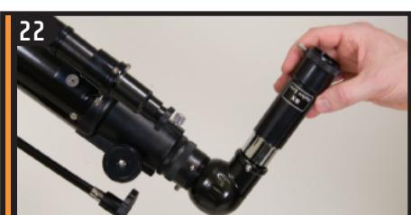
Per ottenere un ulteriore ingrandimento, si può usare la lente di Barlow da 3x in dotazione. Mettere la lente di Barlow nel focalizzatore al posto dell'oculare – togliere il cappuccio dalla lente di Barlow.
