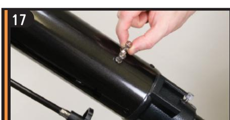
Nehmen Sie die Plastikdeckel an der Vorderseite und Rückseite der Linse ab. Entfernen Sie die Rändelmuttern am Fokussierende des Teleskoprohrs.
