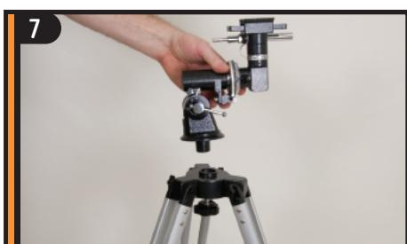
Individuare la montatura equatoriale e disporne la base inserendola nel foro situato al centro della piattaforma di montaggio del treppiedi.
