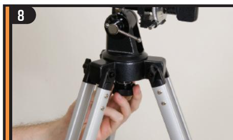
Dalla parte inferiore della piattaforma di montaggio della montatura, avvitare nel foro presente sul fondo della montatura equatoriale il bullone di montaggio collegato.
