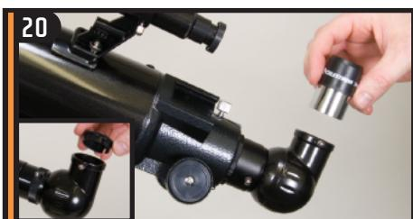
Retirez le cache et insérez l'oculaire de 20 mm dans le renvoi à 90° avant de serrer la vis de blocage.
