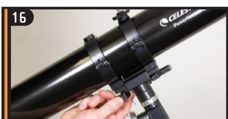
Vuelva a colocar ambos botones y apriete para asegurarlos en su lugar. La parte anterior del tubo debe situarse sobre el ensamblaje del contrapeso.
