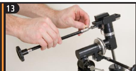
Das längere Kabel ist an der RA-Achse und das kürzere Kabel ist an der Deklinationsachse anzuschließen. Ziehen Sie die Schraube fest an.
