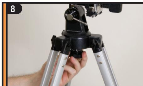
Desde la parte inferior de la plataforma del montaje del trípode, enrosque el perno de montaje dentro del orificio de la parte inferior del montaje ecuatorial.
