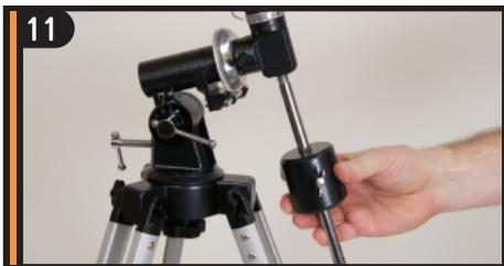
Enrosque el extremo roscado de la barra de contrapeso en el eje de declinación del montaje ecuatorial.
