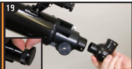
Drehen Sie die Stellschrauben am Fokussierer los, so dass sie den Innendurchmesser des Fokussierers nicht behindern. Stecken Sie den Zenitspiegel in den Fokussierer und ziehen Sie die Einstellschraube an.
