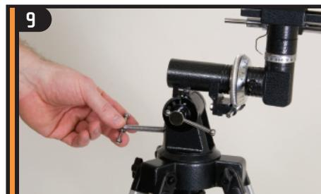
Enrosque el tornillo de ajuste de la latitud en el montaje ecuatorial hasta que entre en contacto con el interior del montaje.
