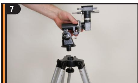
Ubique el montaje ecuatorial y coloque la base del mismo en el orificio del centro de la plataforma del montaje del trípode.
