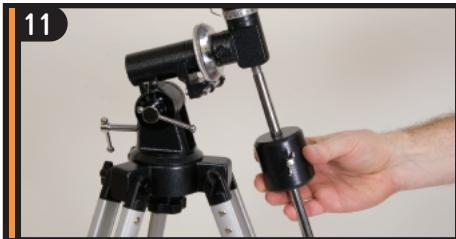
Avvitare l'estremità filettata della barra dei contrappesi nell'asse di Declinazione della montatura equatoriale.
