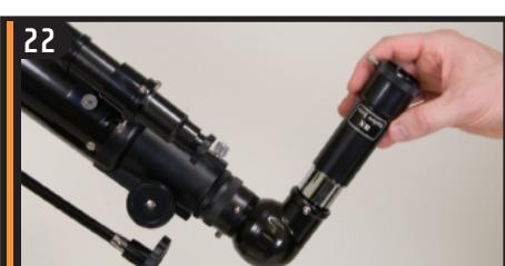
Für zusätzliche Vergrößerung können Sie die im Lieferumfang enthaltene 3x-Barlow-Linse verwenden. Setzen Sie die Barlow-Linse an Stelle des Okulars in den Fokussierer – entfernen Sie den Deckel von der Barlow-Linse.
