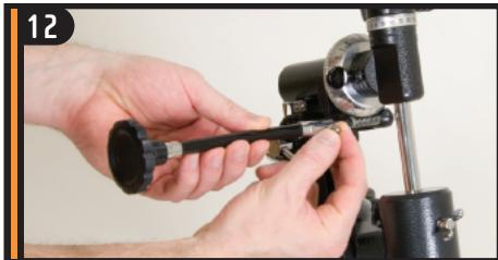
Insérez l'extrémité chromée du câble de contrôle lent sur la tige d'engrenage de la monture équatoriale et serrez la vis pour le maintenir en position.
