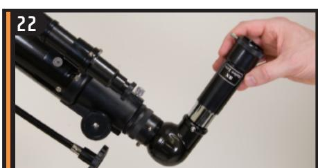
Pour un grossissement supplémentaire, vous pouvez utiliser la lentille de Barlow 3x incluse. Placez la lentille de Barlow dans le dispositif de mise au point au lieu de l'oculaire — retirez le cache de la lentille de Barlow.
