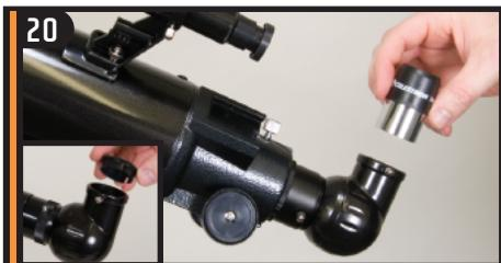
Retire la tapa e inserte el ocular de 20 mm dentro de la lente a 90° y ajuste el tornillo de fijación.
