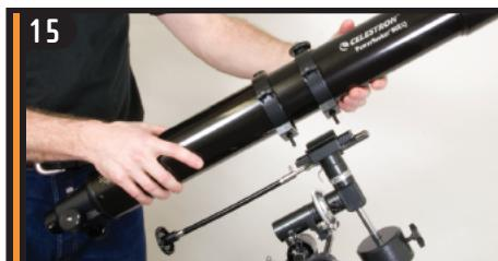
Disporre il tubo del telescopio sulla montatura allineando le viti con i fori di montaggio presenti su di essa.
