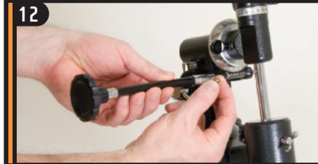
Schieben Sie das verchromte Ende des Zeitlupe-Kontrollkabels auf die Zahnradwelle der parallaktischen Montierung und ziehen Sie die Schraube fest an.
