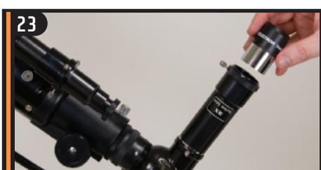
Placez l'oculaire dans la lentille de Barlow et serrez la vis de blocage pour le maintenir en place.
