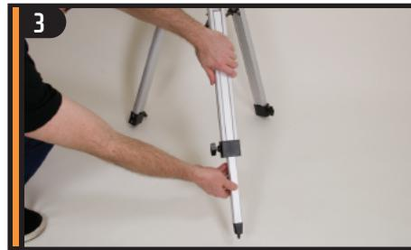
Deployez la partie centrale de chacun des pieds du trépied sur 15-30 cm (6-12 po). Utilisez les trois vis de blocage situées en bas de chacun des pieds pour les fixer solidement une fois déployés.
