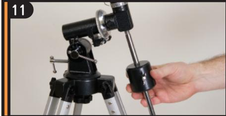
Das Gewindeende der Gegengewichtsstange fest in die Deklinationsachse der parallaktischen Montierung eindrehen.
