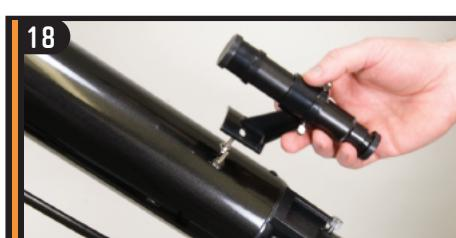
Richten Sie das Sucherfernrohr so aus, dass das Glasfenster der Vorderseite des Tubus zugekehrt ist. Setzen Sie das Sucherfernrohr über die Öffnungen im Tubus und setzen Sie die Rändelmuttern zur Sicherung wieder an.
