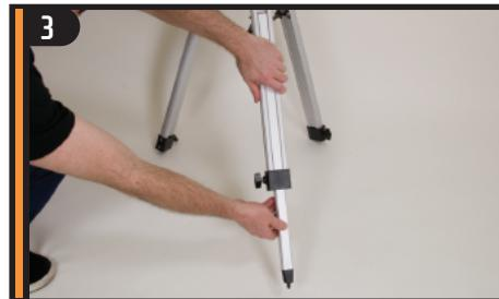
Estendere la porzione centrale di ciascuna delle gambe del treppiedi fino ad ottenere una lunghezza di 15-30 cm. Usare le tre viti di serraggio situate in fondo a ciascuna gamba per fissare in posizione le gambe estese.
