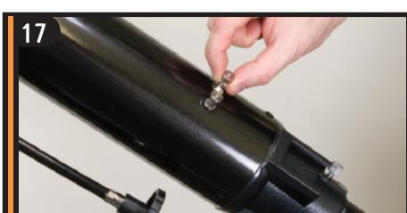
Individuare il cannocchiale cercatore e rimuovere i cappucci di plastica situati sulla lente anteriore e posteriore. Rimuovere i dadi zigrinati all'estremità del tubo del telescopio dove si trova il focalizzatore.
