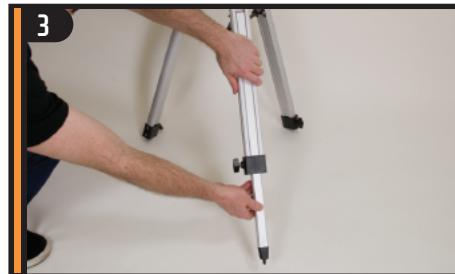
Extienda la parte central de cada una de las tres patas del trípode hacia abajo, de 15 a 30 cm (6 a 12 pulgadas). Una vez extendidas use los tres tornillos de ajuste que se encuentran al pie de cada pata para fijarlas en su lugar.
