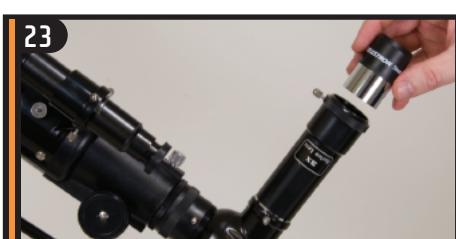
Stecken Sie das Okular in die Barlow-Linse und ziehen Sie die Stellschraube fest, um es zu sichern.
