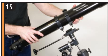
Placez le tube sur la monture en alignant les vis sur les trous de montage de celle-ci.
