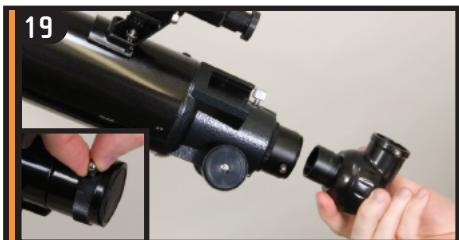
Afloje los tornillos de fijación del mecanismo de enfoque para que no obstruyan el diámetro interno del mismo. Introduzca la lente a 90° dentro del mecanismo de enfoque y apriete el tornillo de fijación.
