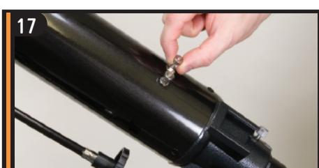
Saque el telescopio buscador y quite las tapas plásticas de la parte anterior y posterior de la lente. Quite las tuercas estriadas en el extremo del mecanismo de enfoque del tubo telescopico.
