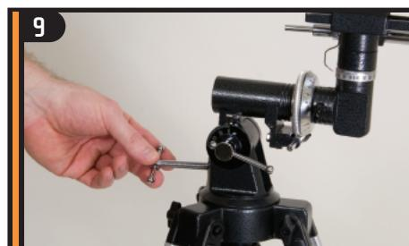
Avvitare la vite di regolazione della latitudine nella montatura equatoriale fino a quando non arriva a contatto con l'interno della montatura.
