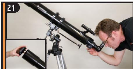
Saque la tapa de la lente de la parte anterior del telescopio. Para hacer una observación, utilice el ocular como se muestra en la imagen anterior.
