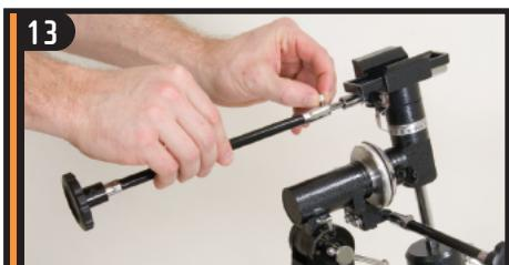
Le plus long des câbles doit être attaché sur l'axe d'ascension droite et le plus court sur l'axe de déclinaison — serrez les vis pour maintenir fermement en position.
