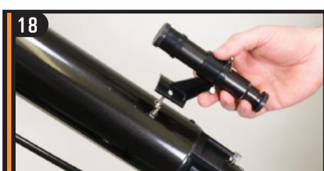
Oriente el telescopio buscador de forma que la ventana de la lente mire hacia la parte anterior del tubo. Coloque el telescopio del buscador sobre los orificios del tubo y vuelva a poner las tuercas estriadas para asegurarla.
