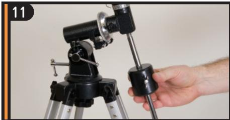
Insérez l'extrémité filetée de la tige de réglage dans l'axe de déclinaison de la monture équatoriale.
