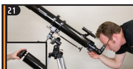
Rimuovere il cappuccio della lente dalla parte anteriore del telescopio. Per eseguire le osservazioni, guardare attraverso l'oculare nel modo illustrato sopra.
