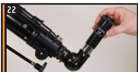
Para obtener más aumento, puede utilizar la lente Barlow 3x incluida. Coloque la lente Barlow en el mecanismo de enfoque en lugar del ocular; retire la tapa de la lente.
