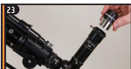
Mettere l'oculare nella lente di Barlow e serrare la vite di fermo per fissarlo in posizione.
