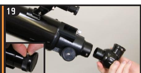
Allentare le viti di fermo sul focalizzatore in modo che non sporgano nel diametro interno del focalizzatore. Inserire il diagonale nel focalizzatore e serrare la vite di fermo.
