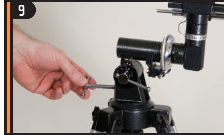
Enfilez la vis de réglage de la latitude dans la monture équatoriale jusqu'à ce que cette vis touche l'intérieur de la monture.
